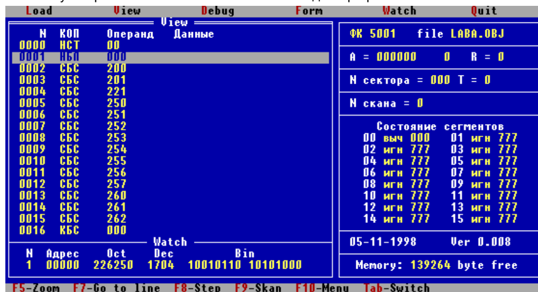
Рис.3 Эмулятор ПЛК із завантаженням об'єктним кодом програми замкненої САР
